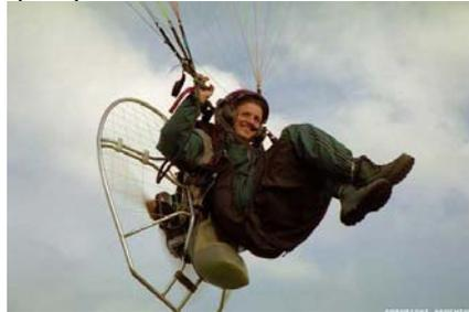
Des moteurs plus puissants et des voiles plus grandes permettent le vol biplace pour les baptêmes par exemple. On trouve désormais également de chariots ultralégers sur les quels on peut fixer la motorisation. On parle alors plutôt de **Paraplane**.
