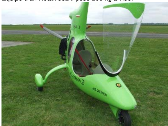
On distingue les échancrures dans la verrière
