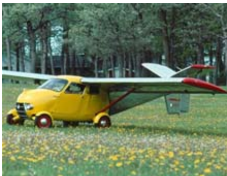
L'Aérocar de Taylor (1949) Construite à 6 exemplaires, la partie avion démontée était remorquable. L'hélice propulsive est au bout de la queue.
