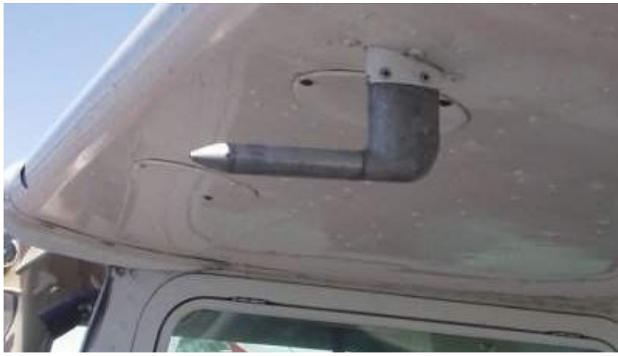
Sur cet avion de tourisme, la sonde est placée sou l'aile, alors que sur cet Airbus elles sont sur le fuselage.
