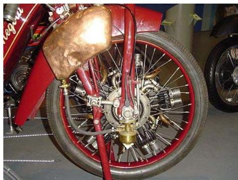
directement sur la roue, arrière sur la **Millet** en 1893, ou avant sur la **Mégola** allemande ci-dessous (2.000 exemplaires entre 1921 et 1925).
