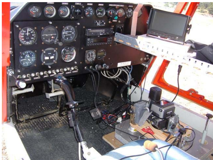
Vue générale du cockpit avec l'écran de contrôle photo.
