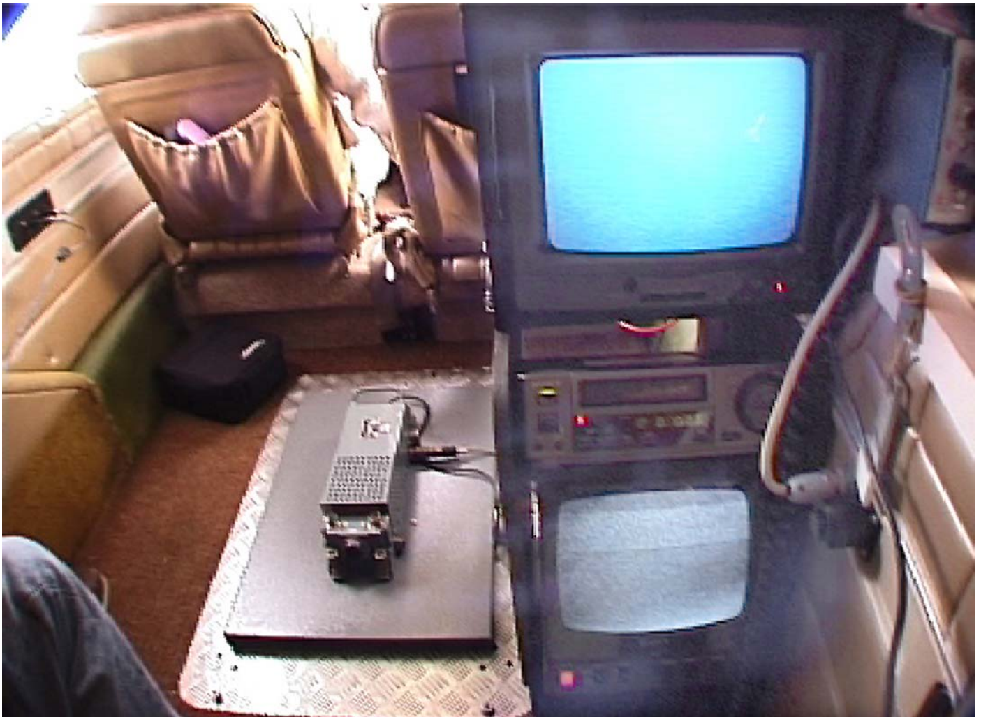
Le matériel de thermographie à bord du Piper (photo P. Aimon)
