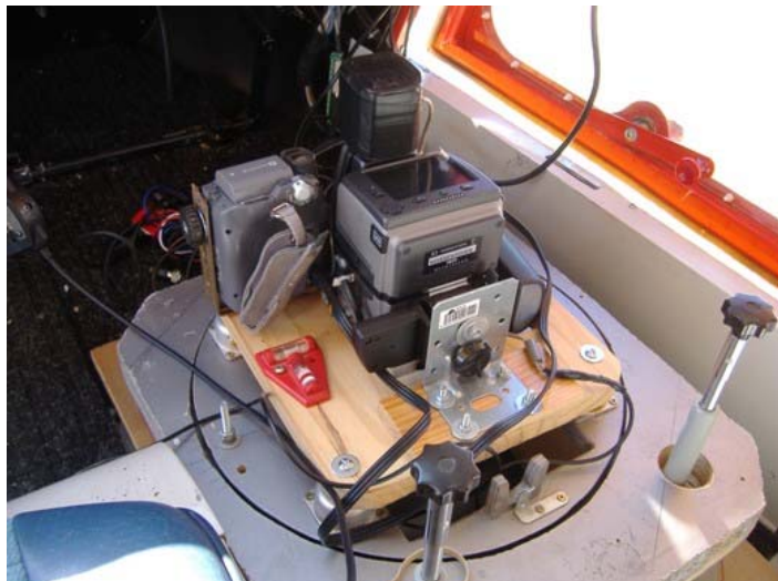
Vue de la platine supportant l'appareil photo. Sur l'œillet de celui-ci, une petite caméra renvoie l'image du viseur vers l'écran de contrôle, alors qu'à gauche, une caméra enregistre la vidéo. Notez les deux niveaux permettant de contrôler l'horizontalité de l'ensemble.
