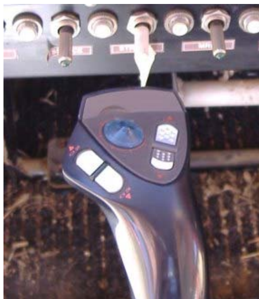
Le manche a été adapté pour commander aussi les appareils photos
