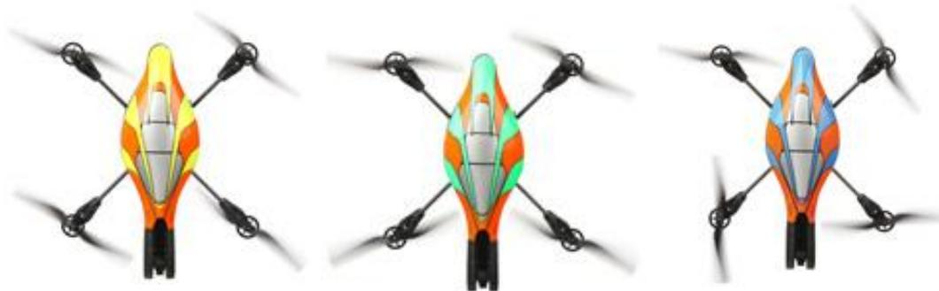
En intérieur, une carène spécifique protège les hélices dans le cas où elles touchent un obstacle. Blanc, gris et noir, le cockpit est sobre. Des autocollants, qui reprennent les couleurs de la carène extérieure, peuvent être fixés sur chaque arceau pour permettre, en intérieur, des combats de drones.
