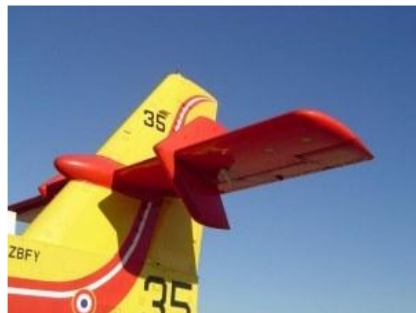
Les winglets, le bulbe et les dérives auxiliaires ajoutés du fait de la nouvelle motorisation lui donnent son allure caractéristique
