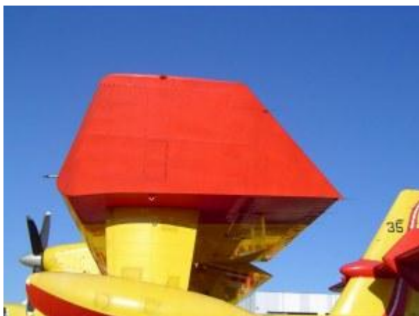
Les winglets, le bulbe et les dérives auxiliaires ajoutés du fait de la nouvelle motorisation lui donnent son allure caractéristique
