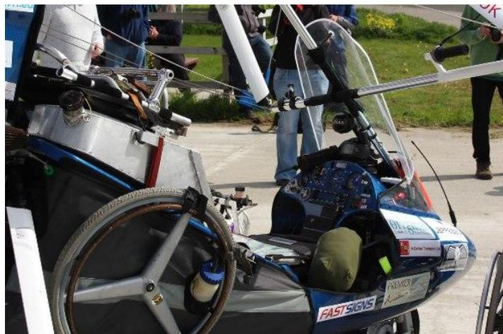
*Notez la manette des gaz installée sur le trapèze, et le réservoir s'essence supplémentaire, qui occupe tout l'emplacement passager, et sur lequel est fixée la chaise roulante démontée*
