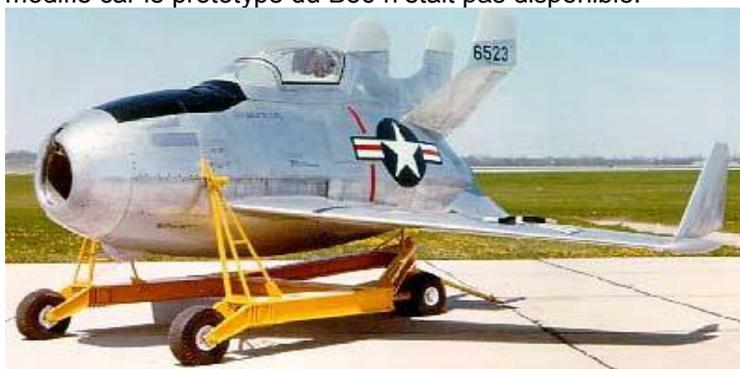
*Le Goblin sur son chariot de manutention. Ce second prototype est équipé de winglets en bouts d'ailes.*
