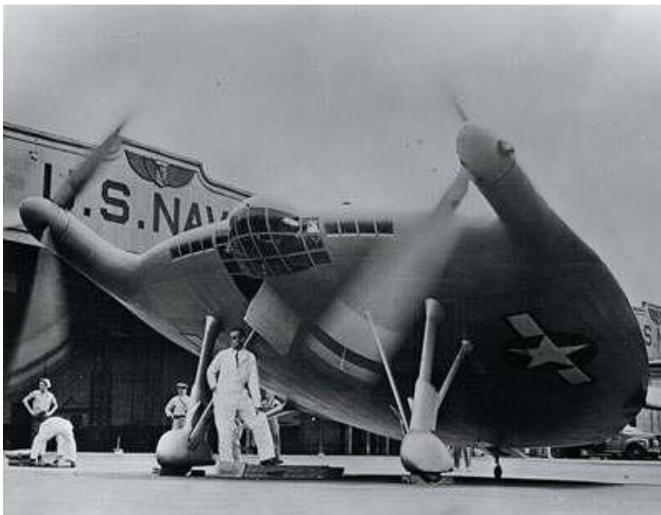
Sur cette photo qui donne une idée de la taille de l'avion, remarquez sur le bord d'attaque les entrées d'air des moteurs qui sont implantés dans l'épaisseur de l'aile de chaque côté du cockpit et reliés aux hélices par un double renvoi d'angle (ci-dessous, la motorisation du XF5U).
