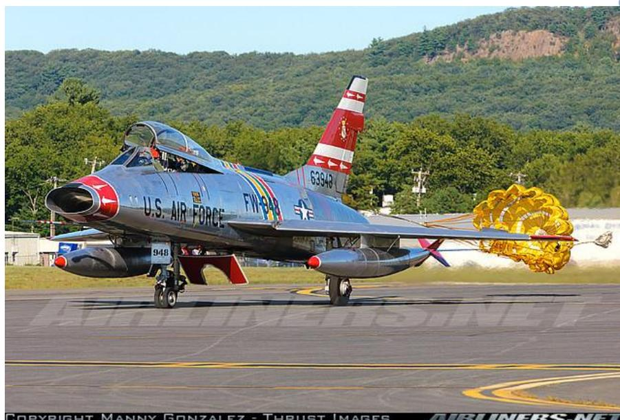
F-100 à l'atterrissage, aérofrein (sous le fuselage) et parachute déployés.
