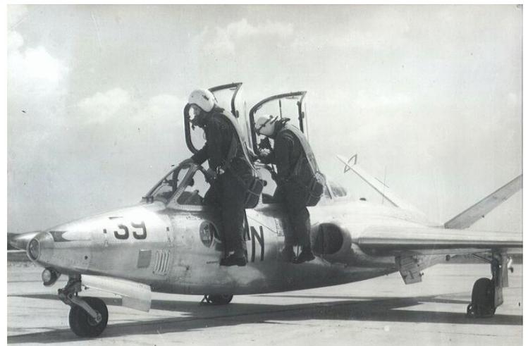
L'avion est équipé en standard de bidons de 125 litres en bout d'ailes, mais pour les vols longs il peut recevoir des bidons de 230 litres. Il peut être équipé de deux mitrailleuses MAC52 (7,5 mm) avec 2 x 140 cartouches dans le nez (photo ci-contre) ainsi que de roquettes ou de bombes sous les ailes.
