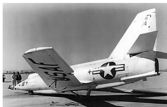
Cette photo du Bell X-2, successeur du X-1, montre bien l'empennage monobloc
