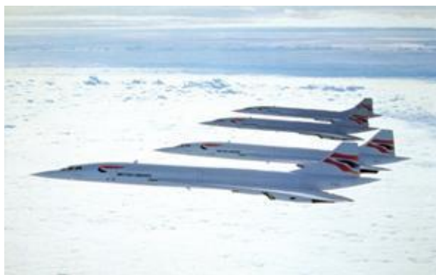
Pour gérer le problème de variation du centre de poussée aux différentes vitesses, le Concorde transférait en vol une partie de son carburant entre les réservoirs avant et arrière
