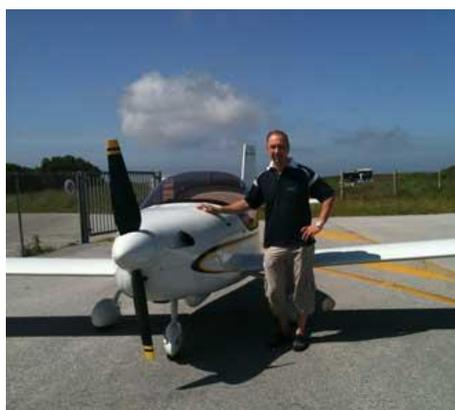
*80 kg pour le pilote, 35 kg de bagages, 54 kg pour les 67l de carburant, et 280 kg de masse à vide, soit 449 kg de masse au décollage.*
